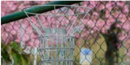
15 RÉSEAUX DE MESURE DES RETOMBÉES DE POUSSIÈRES PAR SÉDIMENTATION
