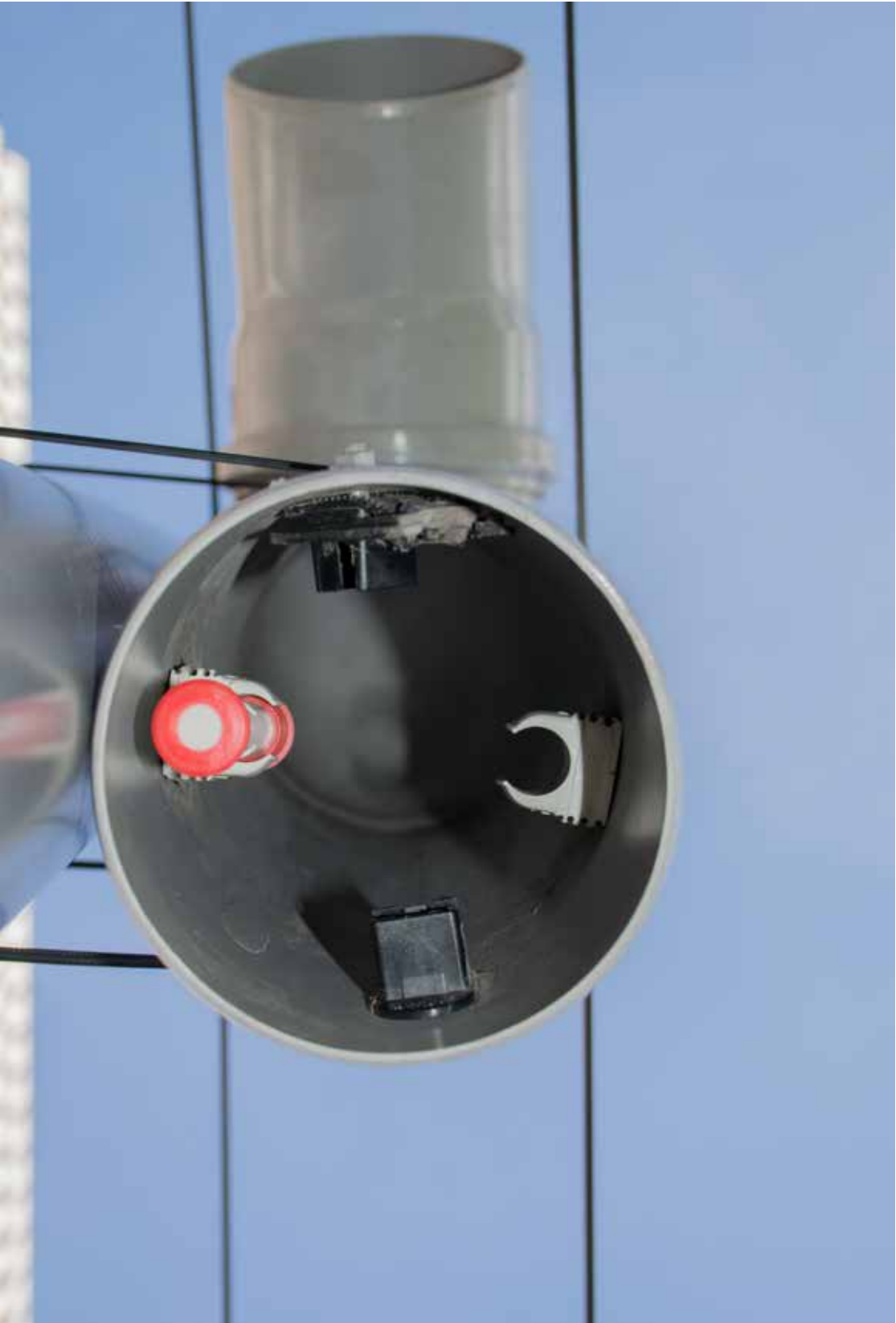
Installation « tube à diffusion passive »
